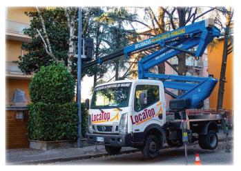
Noleggio di piattaforme semoventi autocarrate fino a 25 metri di altezza conducibili con Pat B e fino a 27 metri di altezza conducibili con Pat C
