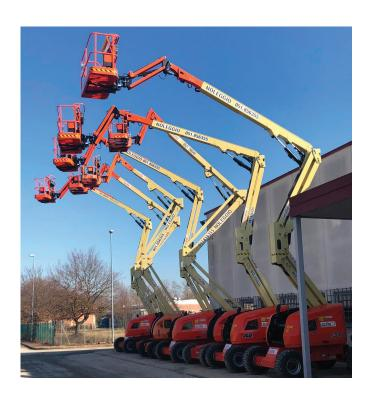
Le Piattaforme aeree semoventi articolate a braccio con alimentazione diesel selezionate da LocaTop sono mezzi particolarmente indicati per operare all'aperto su terreni accidentatio con dislivelli grazie alle quattro ruote motrici, all'asse oscillante, alle alte velocità di movimento e alla grande manovrabilità del posizionamento della macchina.
